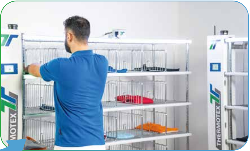
Étape 3 : Un signal lumineux rouge indique clairement un compartiment incorrect et empêche de manière fiable toute erreur d'affectation. Le signal vert confirme le bon compartiment — le linge est correctement trié et le processus est achevé avec précision.
