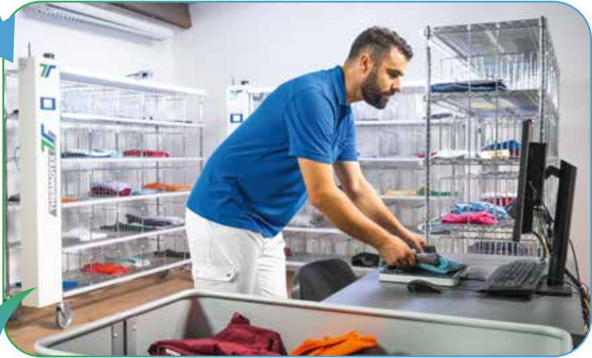
Étape 2 : Grâce à la lecture du code-barres, du code Datamatrix ou à l'identification RFID, chaque vêtement est attribué de manière univoque et préparé pour le tri.
