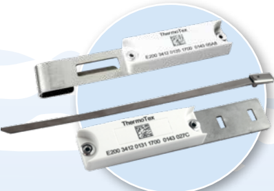
C2 mit Lasergravur und Halterung
