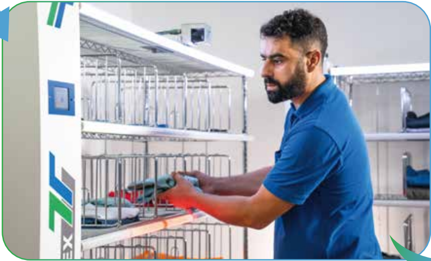
Schritt 3: Ein rotes Leuchtsignal weist klar auf das falsche Fach hin und verhindert zuverlässig eine fehlerhafte Zuordnung. Das grüne Signal bestätigt das richtige Fach — die Wäsche ist korrekt einsortiert und der Prozess sauber abgeschlossen.
