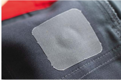
HF-Transponder mit Patchmaterial (PA)
