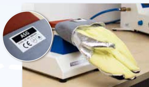
Étiquette ignifugée avec indications fabricant dans les gants de soudeur
