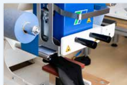
Impression avec ruban encreur spécial de marquage à chaud
