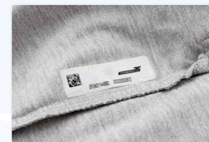
Mietberufskleidung mit F10 Transponder: innen seitlich
